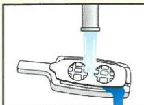
⑤約30秒経過したら、スライドカバーの穴に水道水を注ぎ、検査試液を洗い流して下さい。
